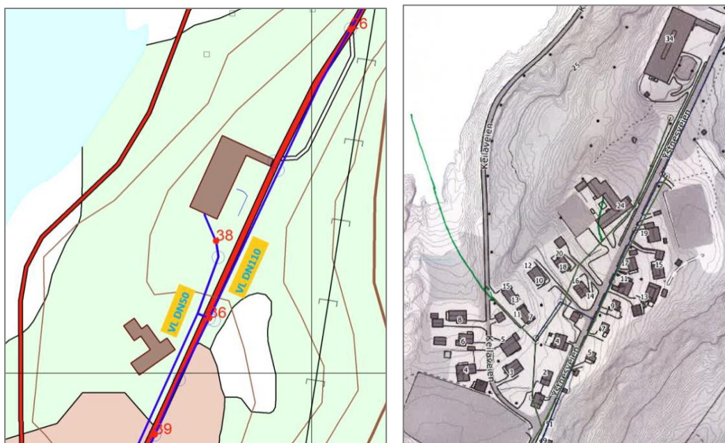
Figur 23: Eksisterende vann- (blå) og avløpsledninger (grønne linjer)
