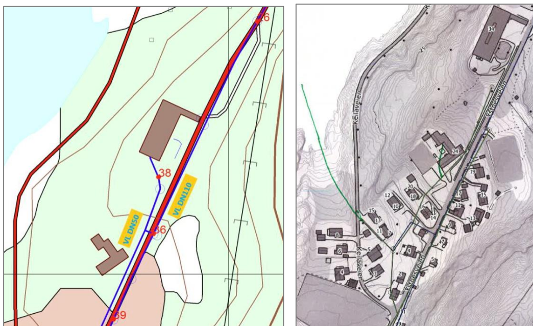
Figur 23: Eksisterende vann- (blå) og avløpsledninger (grønne linjer)
