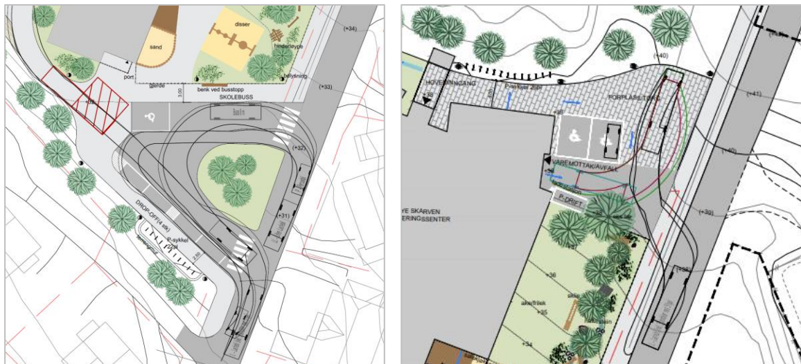
Figur 38: Utklipp fra utomhusplan med mulige løsninger. Venstre bilde adkomst i sør og høyre bilde adkomst i nord. Innkjøring i sør med sporingskurver for personbil og minibuss. Innkjøring i nord med sporingskurver for lastebil til varelevering og renovasjon. Oppstillingsplass for brannbil er vist med rød skravur.
