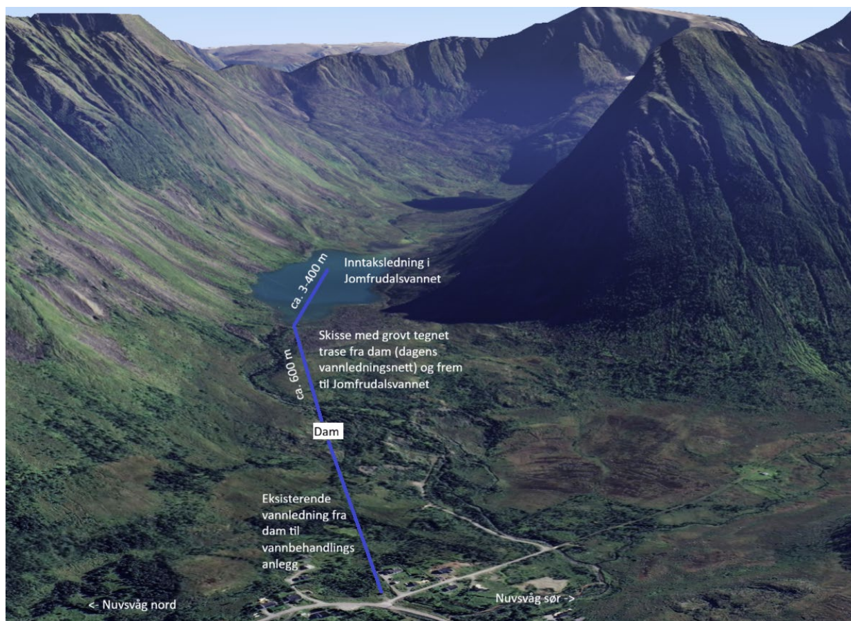
Figur 9: Bilde viser grovt skissert vannledningstrase fra Jomfrudalsvannet til eksisterende vannledningsnett ved dammen.
