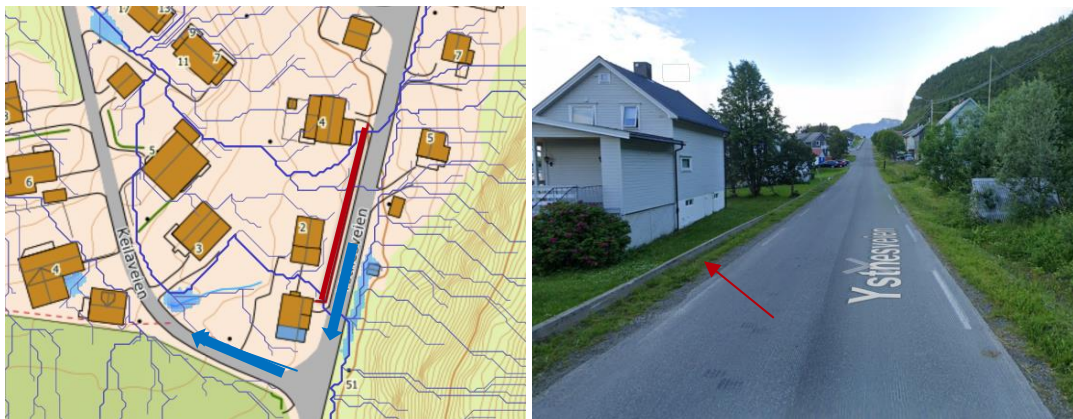
Figur 15 – Det er registrert en forhøyet mur i området markert med rødt (scalgo,2023). Denne vil avskjære dreneringslinjene. Det antas derfor at dreneringslinjene følger Ystnesveien sørover og mot Keilaveien, vist med blå piler.
