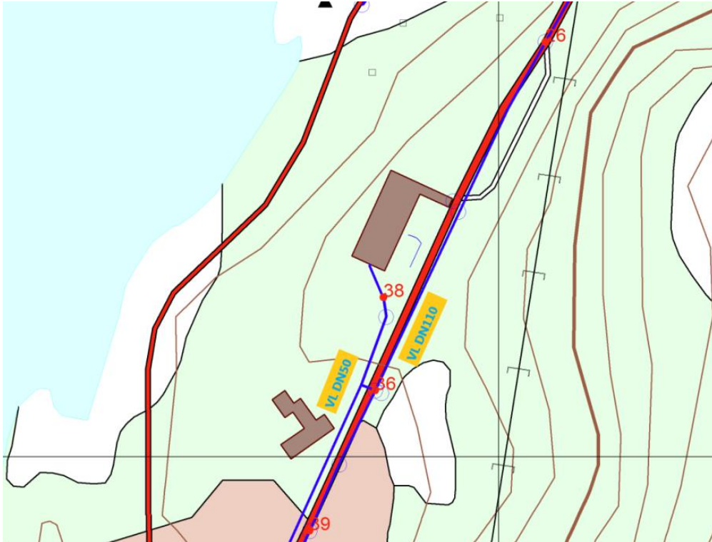
Figur 23 – Viser antatt dimensjoner på eksisterende vannledninger.
