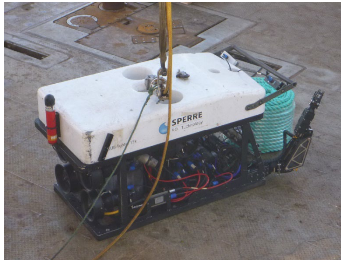
Figur 4. Illustrasjonsbilde av Sperre ROV (type sub-fighter15k) som ble benyttet ved ROV-kartlegging.
