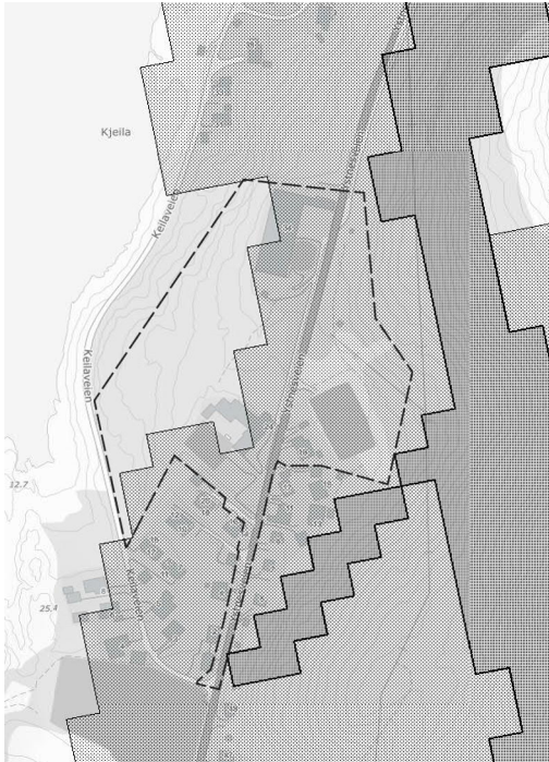
Figur 7 Steinsprang. Mørke partier er utløsningsområder.
